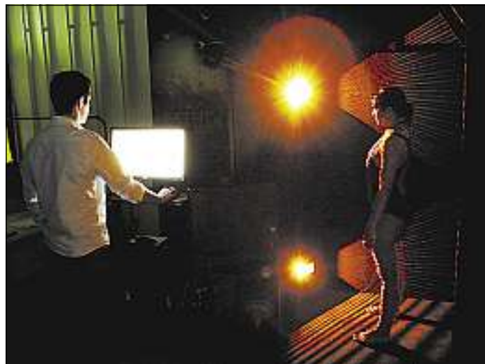
COMPUTADOR aciona o scanner, que dispara 16 sensores de luz
